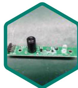
Высокоточный медицинский инфракрасный датчик термометра.
