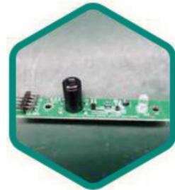
Высокоточный медицинский инфракрасный датчик термометра.
