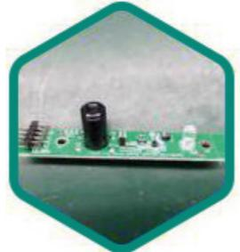
Высокоточный медицинский инфракрасный датчик термометра.
