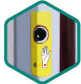
Бесконтактное измерение температуры тела на расстоянии от 1 до 50 см. Время измерения составляет менее 0,5 секунды.
