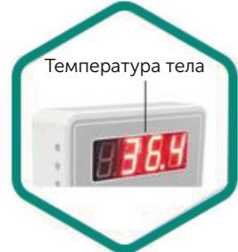
Светодиодный дисплей показывает значение температуры. Нижние и верхние пороги срабатывания тревог – программируемые.
