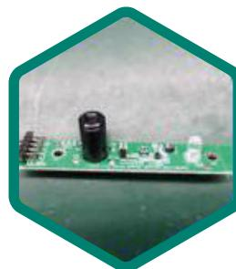
Высокоточный медицинский инфракрасный датчик термометра.
