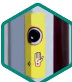
Бесконтактное измерение температуры на расстоянии от 1 до 20 см. Время измерения составляет менее 1 секунды.
