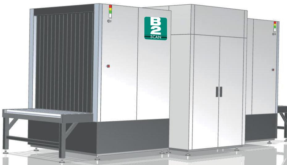
**Рентготелевизионная установка B2scan 180180D** является передовой двухэнергетической системой рентгеновской проверки грузов. Оснащение двумя генераторами рентгеновского излучения обеспечивает отображение проверяемого объекта в двух проекциях. С размерами туннеля 1820 мм x 1820 мм (Ш x В) она идеально подходит для досмотра авиационных контейнеров и паллет в аэропортах.
